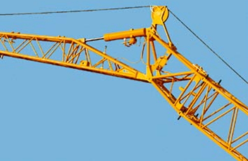
Hydraulisch verstellbare Klappspitze (0° - 40°)
